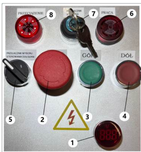
Rys. 14. Elementy sterujące podnośnika dwumasztowego HTLH.
